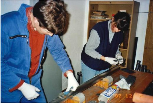
Hand in Hand arbeiten hier Bernhard und Meike von Bodelschwingh an der Reinigung und Politur einer der Orgelpfeifen aus dem sichtbaren Orgelprospekt an der Front.
